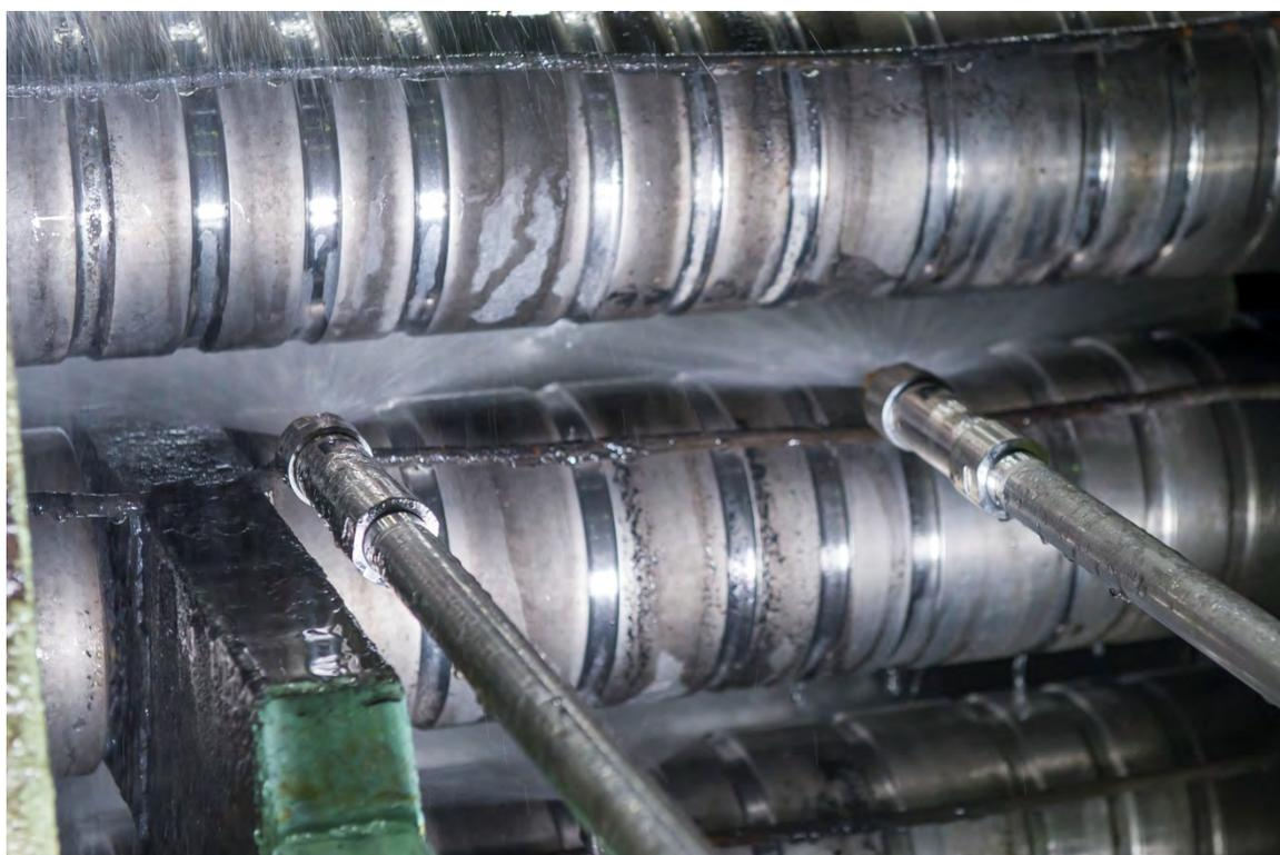
冷却帯に設置されたプライメタルズテクノロジー製のパルス幅可変冷却システム
