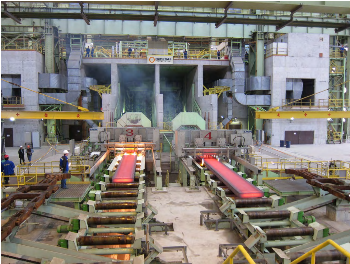
プライメタルズテクノロジーズ製の2ストランド（条）式スラブ連続 casting 機
