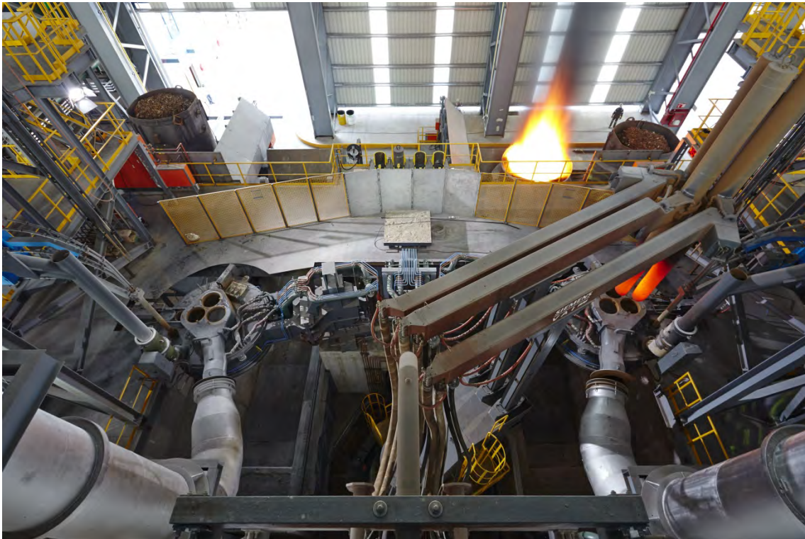
プライメタルズテクノロジーズのツインレールドル炉
