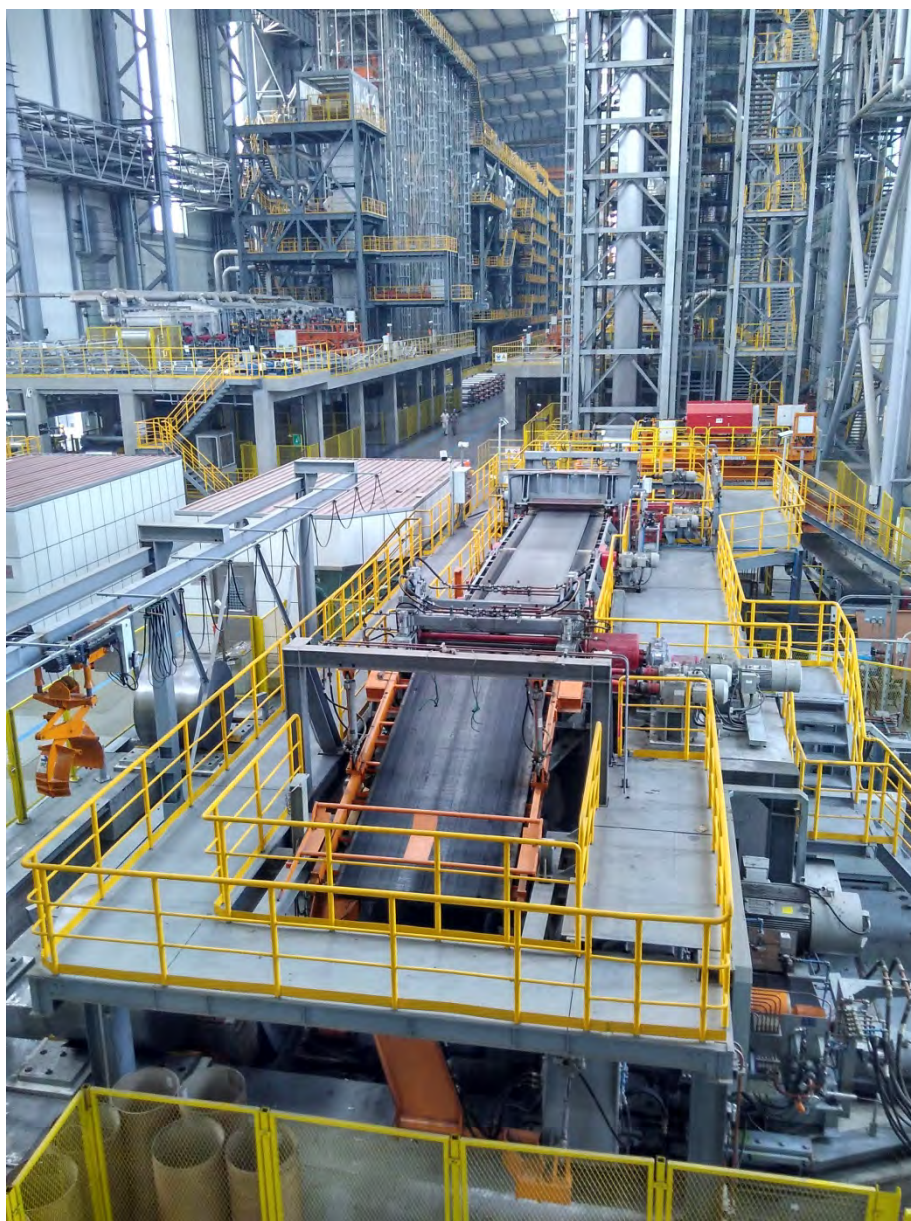
プライメタルズテクノロジーズ製の連続垂鉛めっきライン（CGL）
