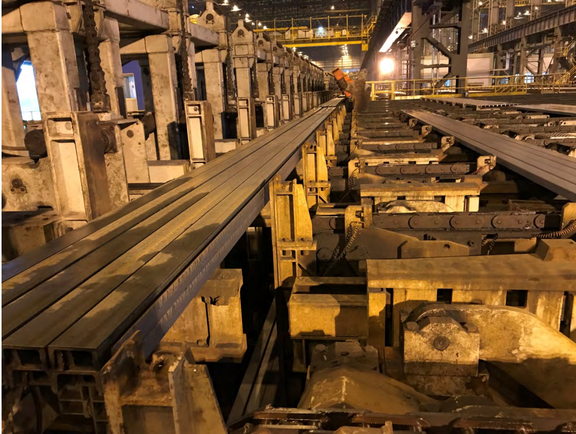
プライメタルズテクノロジーによる形鋼の段積みステーション
