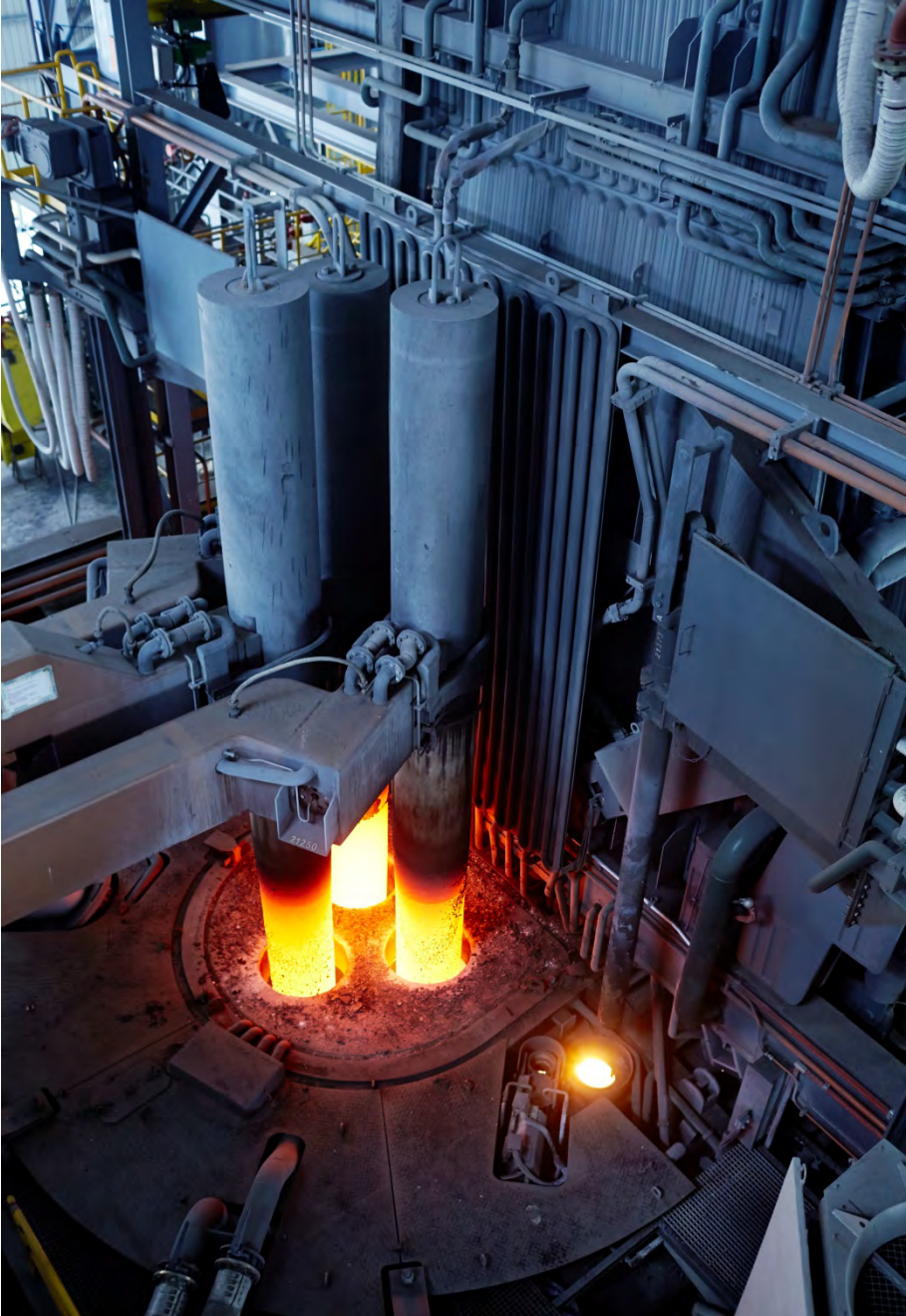
プライメタルズテクノロジーズの新型電気炉 EAF Quantum
