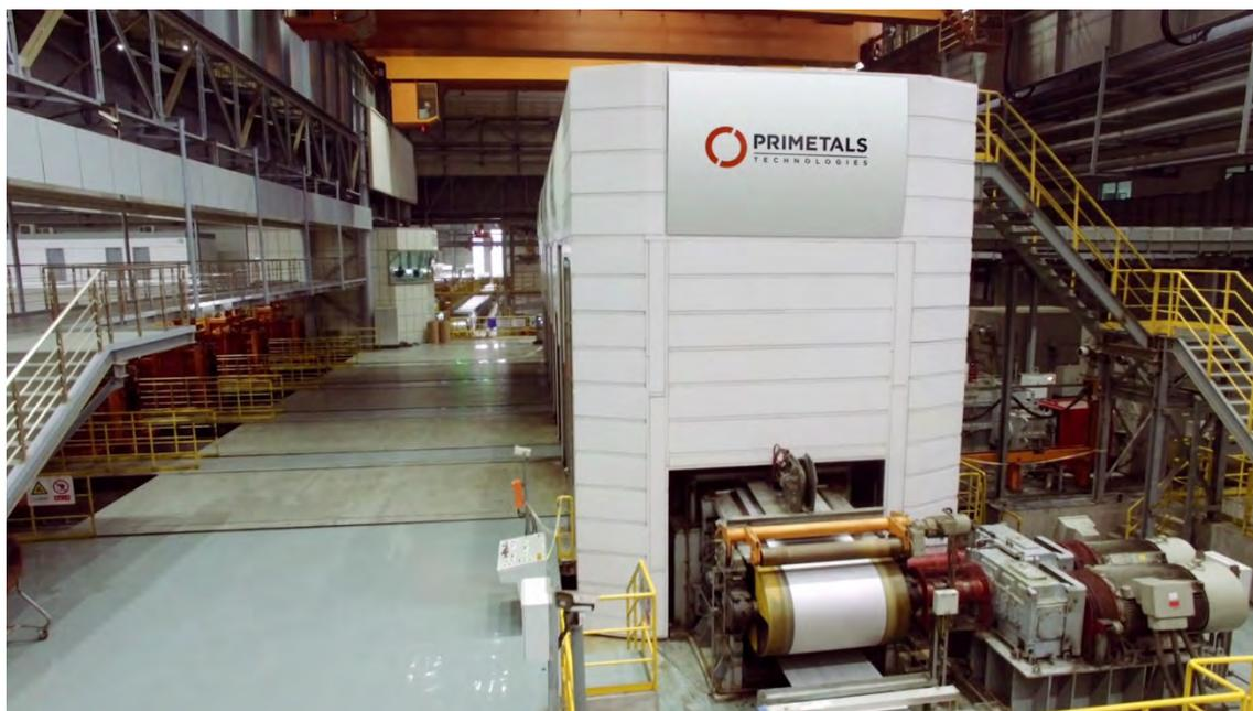
唐山鋼鉄に納入されたプライメタルズテクノロジーズ製冷間圧延機
