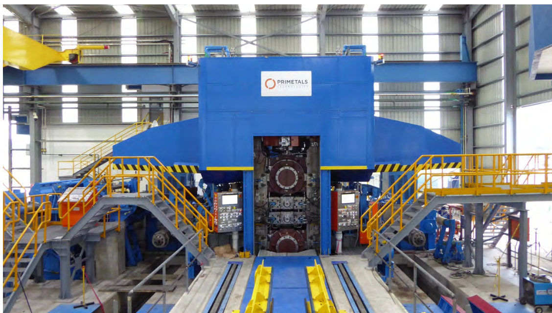
プライメタルズテクノロジーズがメキシコの Tyasa 社に納入した 4 段可逆式冷間圧延機
