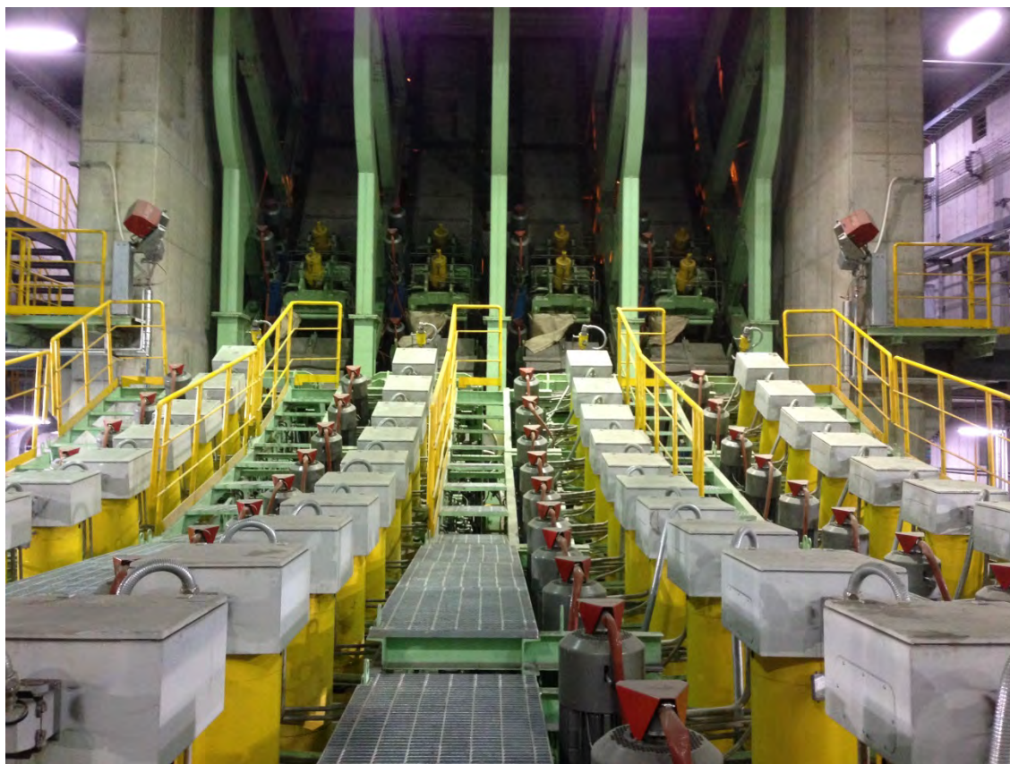
プライメタルズテクノロジーズのブルーム連続鋳造機の湾曲部
