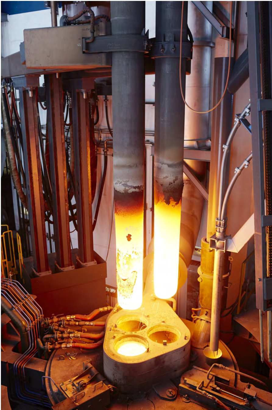
プライメタルズテクノロジーズのレードルヒーティングステーション。
