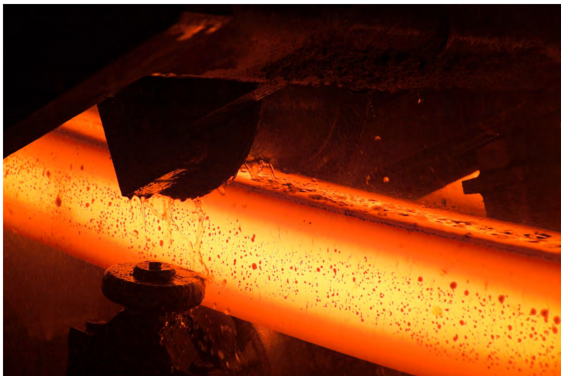
プライメタルズテクノロジーズのビレット鑄造ストランドガイド（参考イメージ）
