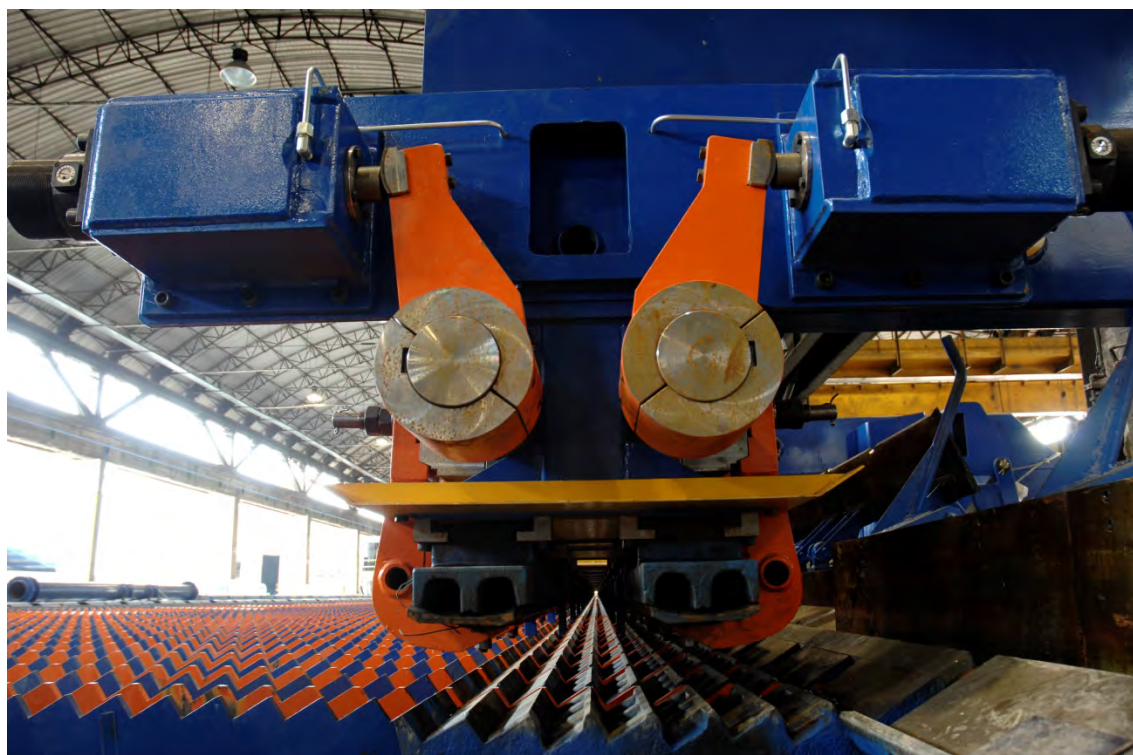
プライメタルズテクノロジーズの棒鋼圧延機用高速搬送システム
