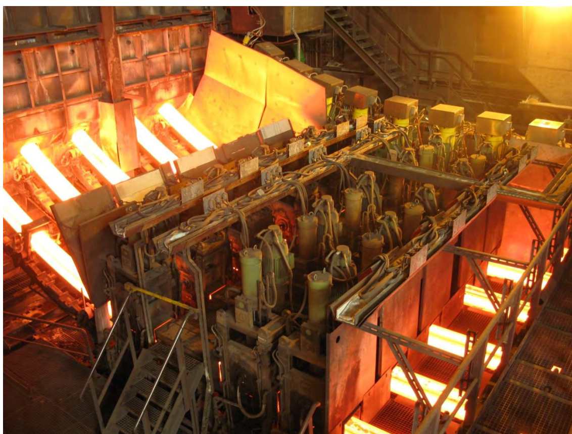
ドイツのゲオルグスマリエンヒュッテ市にあるゲオルグスマリエンヒュッテ社のブルーム連続鋳造機のストランドガイドシステム
