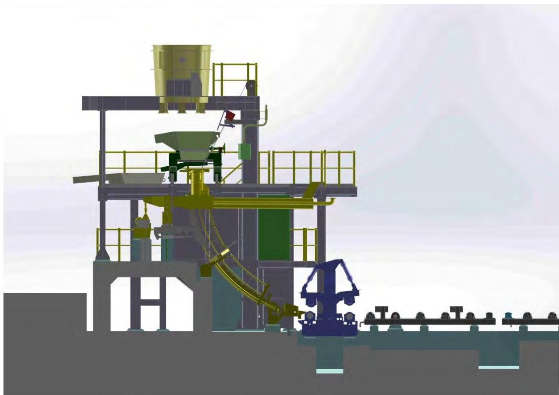
コンキャスト・インドからオリッサ・メタリクス社に納入予定の3ストランド (条)方式ビレット連続鑄造機の断面図 (CG)
