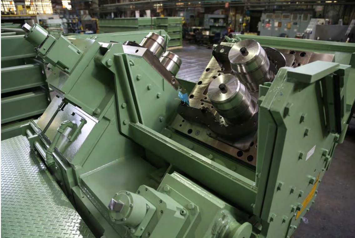
Primetals Technologies の高速線材圧延機用超剛性（UHD）圧延ユニット
