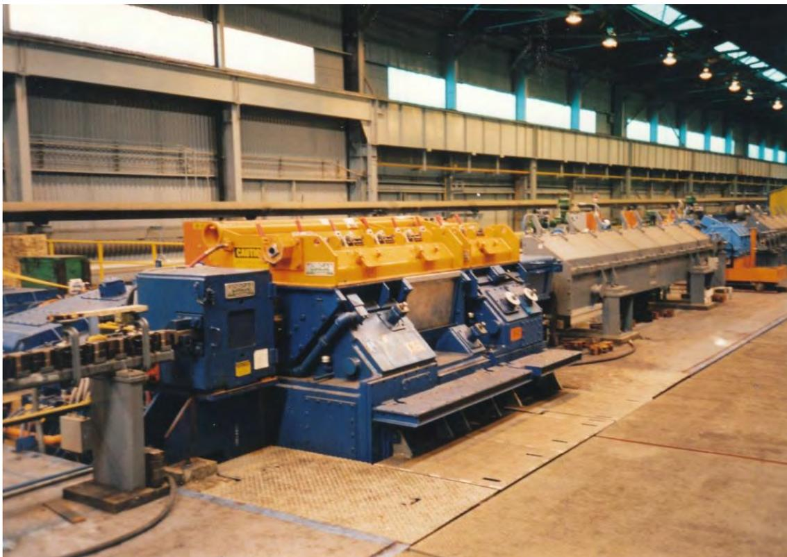
Primetals Technologies が供給する線材圧延機の Morgan 仕上げ圧延機（RSM）
